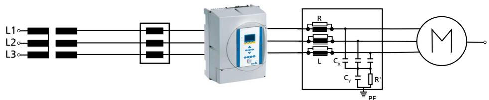
Abb. 13: Netzdrossel und Ausgangsfilter einbauen
